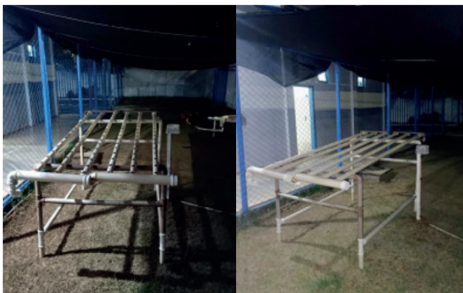
Imagem 1. Construção da bancada hidropônica a partir de canos de PVC
